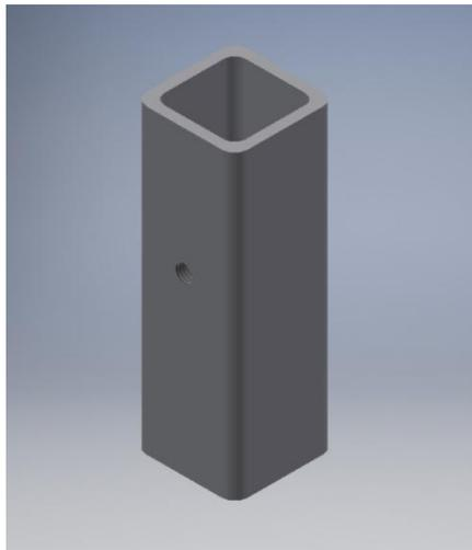
**Figura 10: Tubo hueco 40 mm x 40 mm x 4 mm para anclar mediante tornillo las barandillas**
