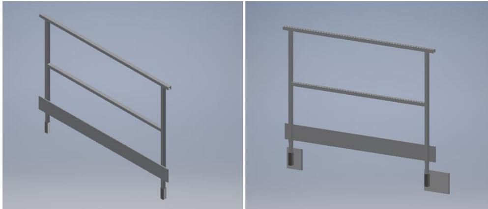
**Figura 9: Ensamblaje barandillas grandes con y sin placas de amarre**
