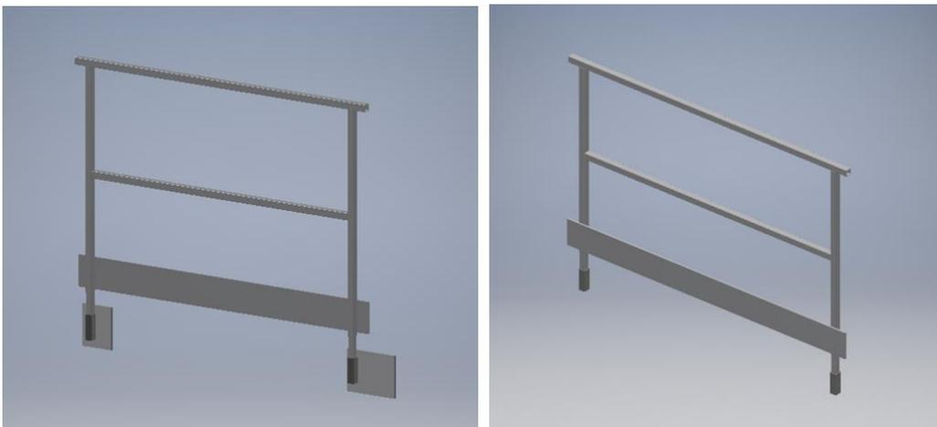
**Figura 8: Ensamblaje barandillas pequeñas con y sin placas de amarre**
