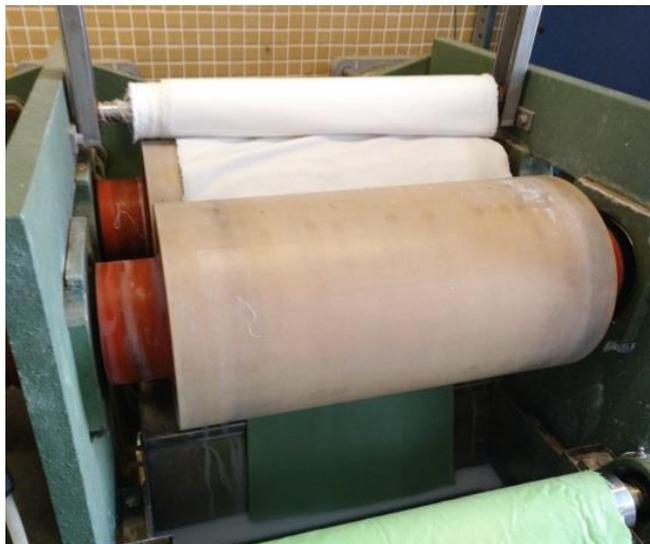
Ilustración 7.- Fulard horizontal modelo 2608 TEPA.
