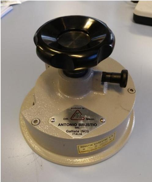
Ilustración 3.- Disco dentado normalizado.
