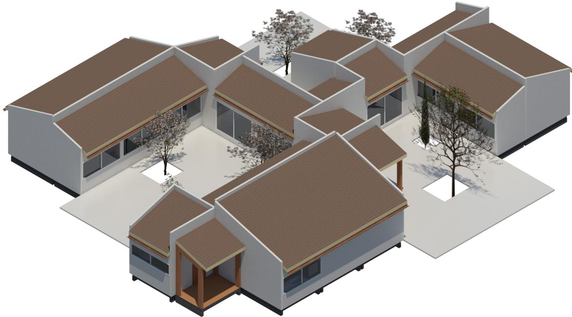
Fig. 3.39. Volumetría con sus respectivas cubiertas a 17°.
