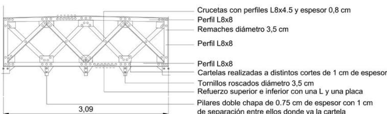
Crucetas con perfiles L8x4.5 y espesor 0,8 cm
