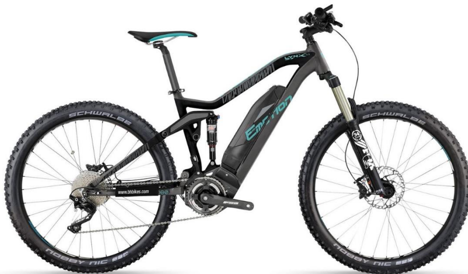
Fig. 7.70 – BH Rebel Lynx 5.5 con motor y batería PW-X ( https://www.bhbikes.com/es_ES/bicicletas/emtb/trail-enduro/rebel-lynx-5-5-27-5-plus-pw-x ).
