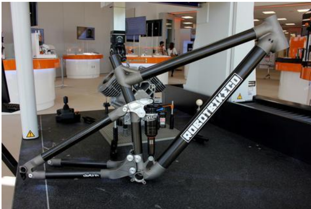
Fig. 7.8 – Bicicleta de montaña R160 ( https://impresoras3d.com/blogs/noticias/181213063-r160-la-primera-bicicleta-totalmente-impresa-en-3d-en-fibra-de-carbono-y-titanio ).
