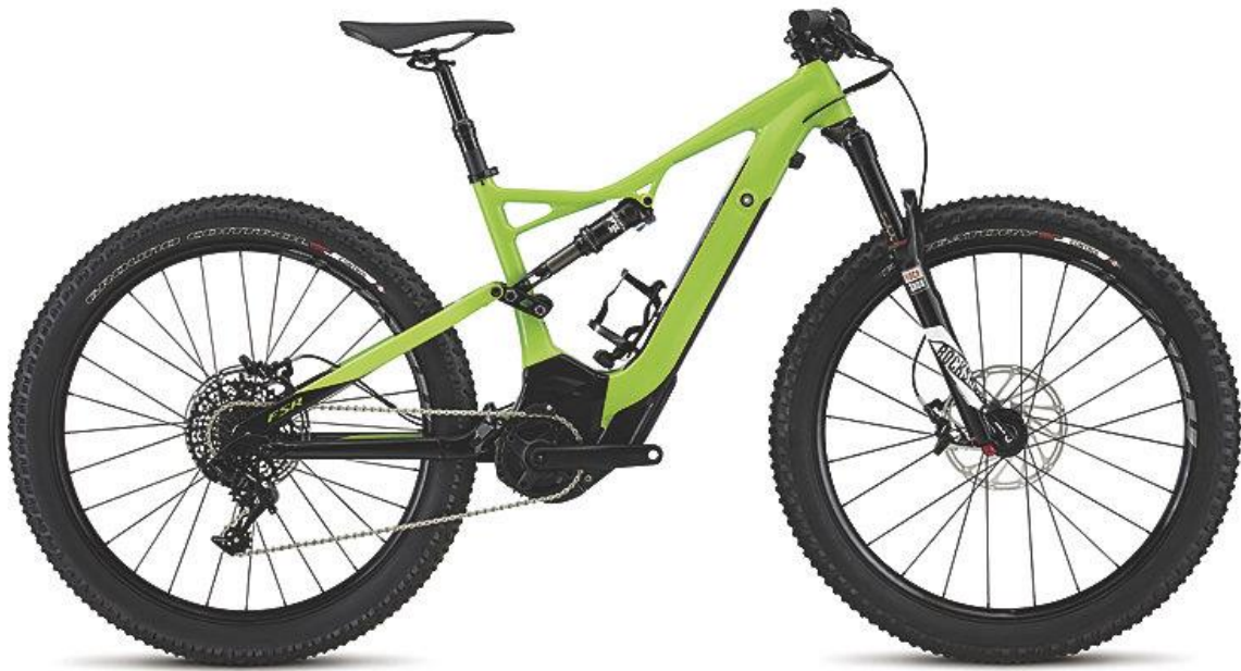
Figura 7.69 – Specialized Turbo Levo FSR con motor y batería Brose ( http://www.mtbpro.es/pruebas-mtb/specialized-turbo-levo-fsr-comp-6fattie ).
