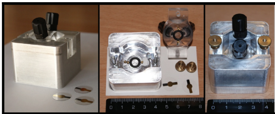
Figura 4.26: Celda de flujo.
