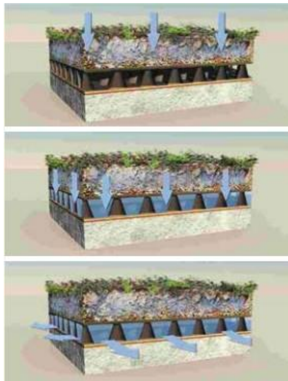
Ilustración 9: Modelo conducción aguas pluviales. Fuente: Projar
