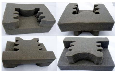
Figura 64. Planchas de polietileno preparadas para adaptarse a la forma de la pieza.
