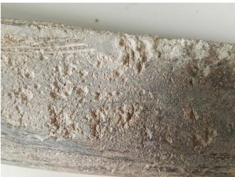
Figura 78. Detalle de los picados en la superficie plúmbea, con restos de carbonatos de plomo o sulfatos.
