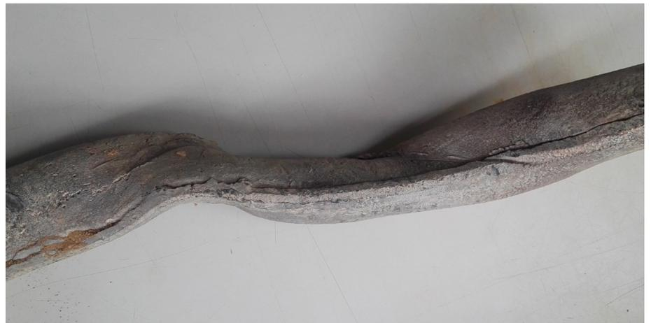
Figura 71. Detalle de la vista superior de la torsión provocada en la tubería.
