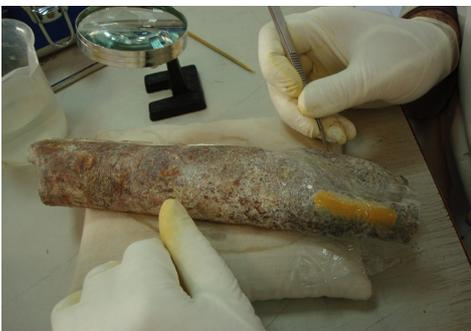
Figura 60. Documentación fotográfica del proceso de aplicación de resina de intercambio iónico en la primera intervención de la tubería.
