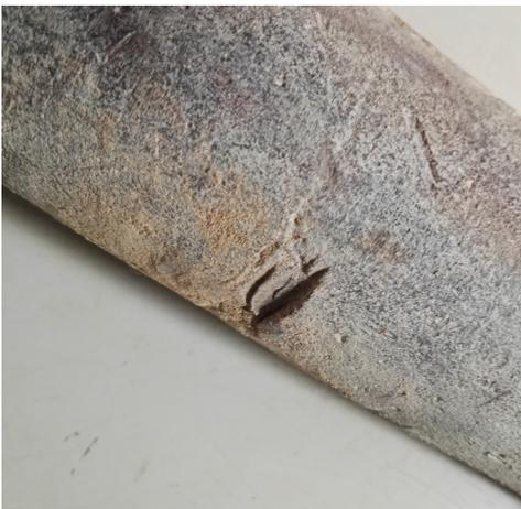
Figura 74. Detalle de un golpe que ha hundido el plomo.
