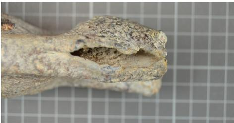
Figura 48. Detalle de la pérdida de la soldadura en la tubería.
