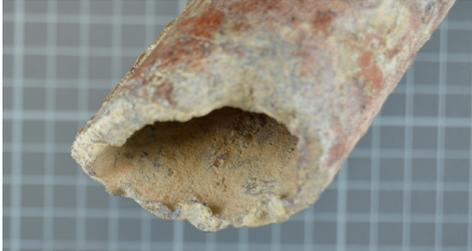
Figura 46. Restos de tierra en el interior de la tubería.
