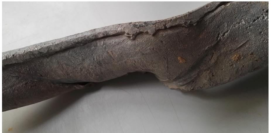
Figura 76. Detalle de la deformación del plomo, y las marcas generadas en la superficie.
