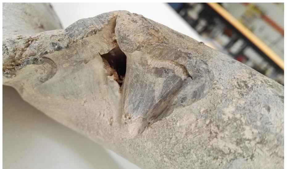
Figura 72. Detalle del agujero en la tubería, posiblemente provocado en el momento en que se torsionó la tubería.
