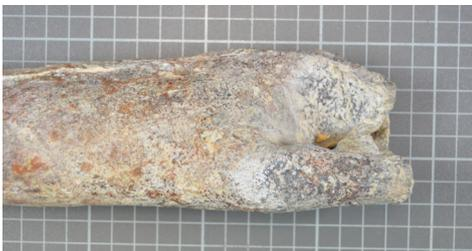
Figura 47. Fragmento de la tubería donde se aprecia la deformación.
