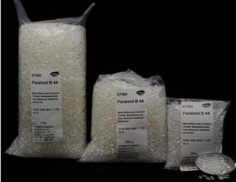
Figura 62. Bolsas de Paraloid B-44 en perlas antes de su preparación y disolución en acetona.
