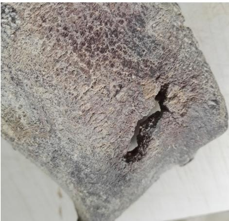
Figura 77. Detalle de un agujero en uno de los extremos de la superficie de la tubería de plomo.
