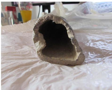
Figura 35. Vista de la tubería objeto de este estudio. Se aprecia la irregularidad de la sección.
