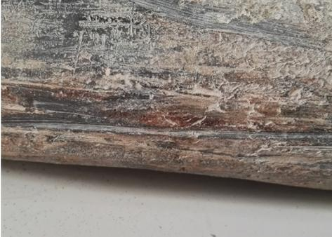
Figura 73. Detalle de las marcas de arrastre a lo largo de la tubería.
