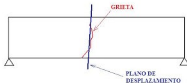
Figura 4.2 [Plano de desplazamiento generado por una fisura].
