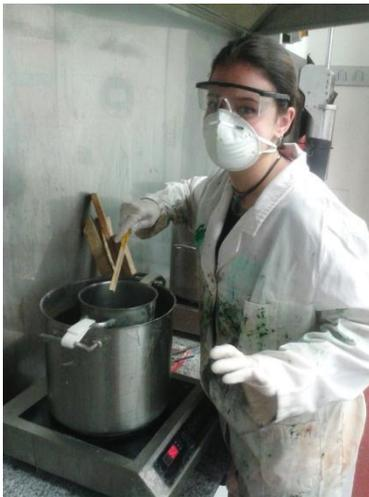
Fig. 52. Proceso de moldeado de cera. Fundición al baño maría
