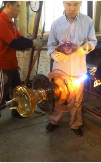
Fig. 60. Proceso de producción de una obra de un compañero, construida por piezas y con la aplicación de pistola de calor para calentar de manera aislada la parte a la que adheriremos la segunda pieza.
