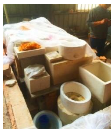
Fig. 81. Imágenes del proceso de colocación del vidrio sobre los moldes antes de introducirlos al horno, donde se filtrarán dentro de sus respectivos huecos para formar las piezas. Shanghái. 2017
