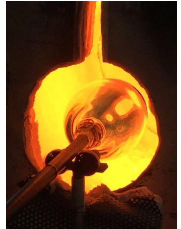
Fig. 57. Proceso de creación de una pieza en el horno para su calentamiento y posterior modelado.
