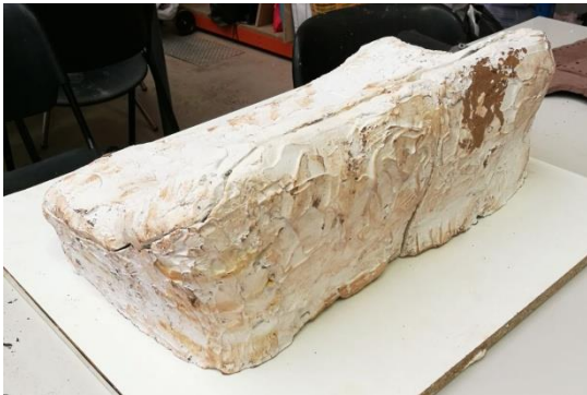
Fig. 78: Molde de escayola de tres piezas del sofá.
