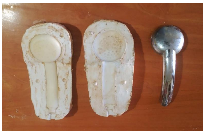
Fig. 122: Molde de escayola de una de las piezas con el referente y la pieza en parafina
