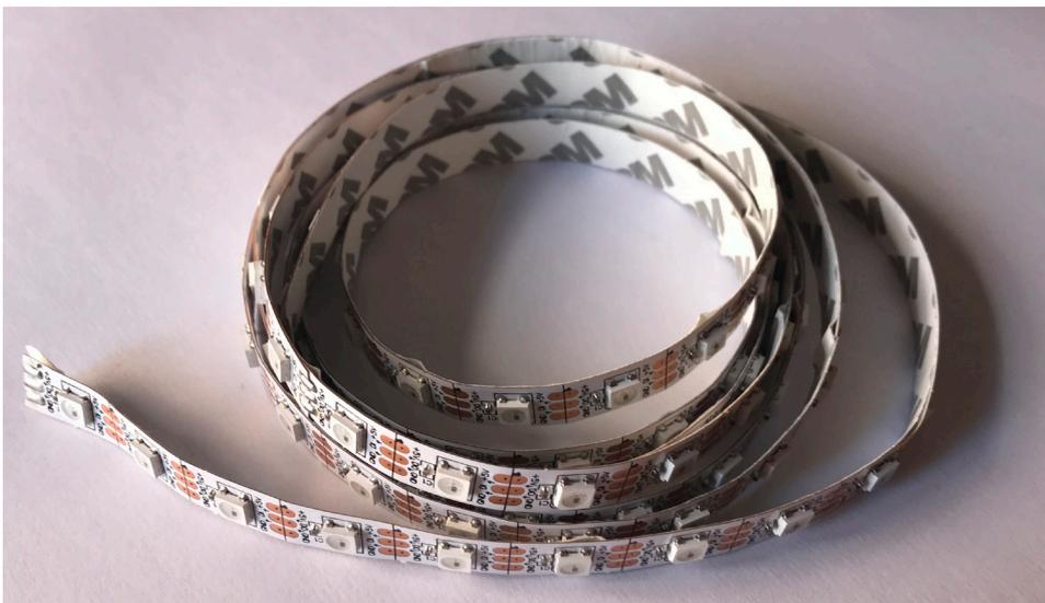
**Ilustración 20.** Imagen que muestra la fuente de Luz LED utilizada. Tipo LED: WS2812B, permite variar el color de cada LED de forma individual. Además su sección más pequeña puede ser de un solo LED.
