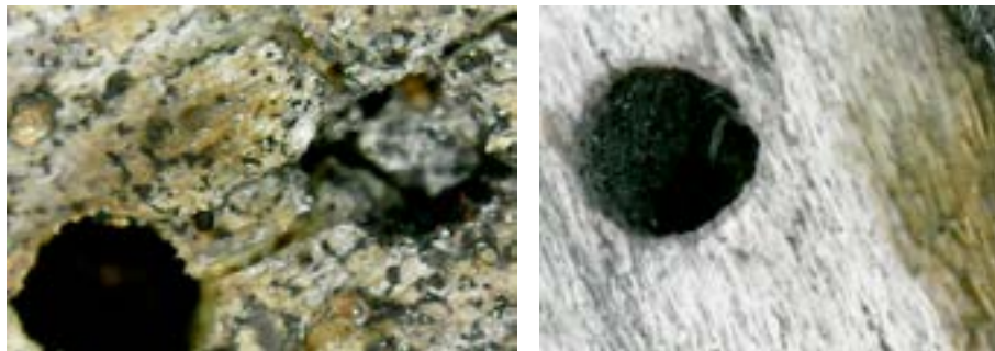
Figura 26. Imagen con microscopio USB de orificios de insecto de xilofago.
