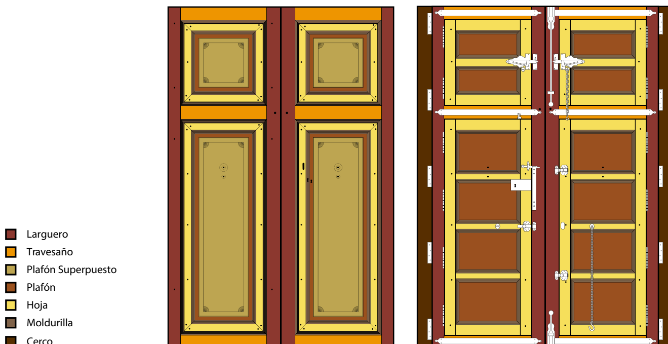
Gráfico 1. Croquis de la cara exterior y de la cara interior de las partes principales que componen la puerta (Anexo 2).
