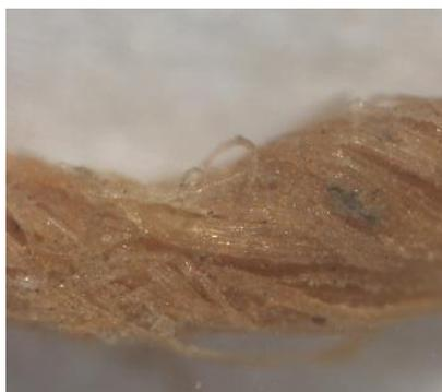
**Figura 16.** Restos de cola en el hilo observado en la lupa binocular a 50 aumentos
