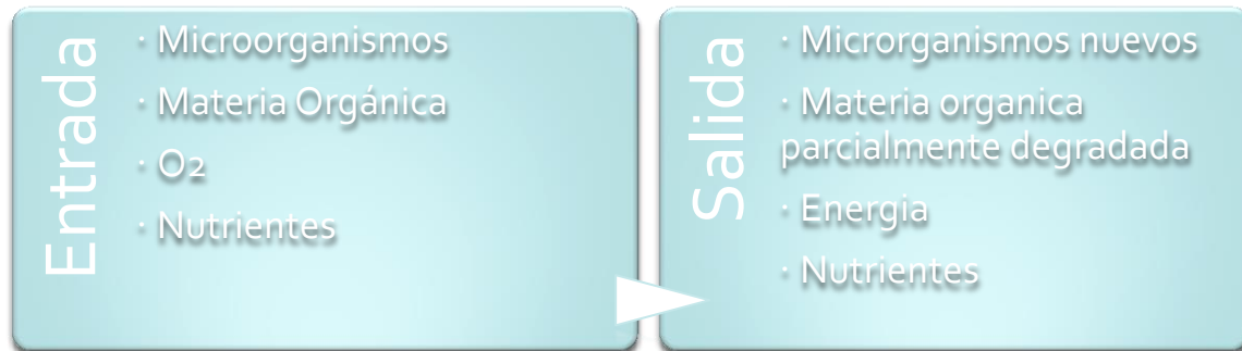
Figura 11. Reactivos y productos del reactor biológico.
