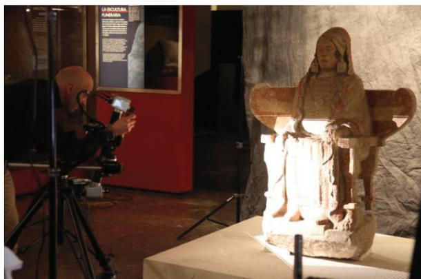
*Fig. 3 Toma de datos mediante escáner de luz blanca estructurada en el MAN.*
