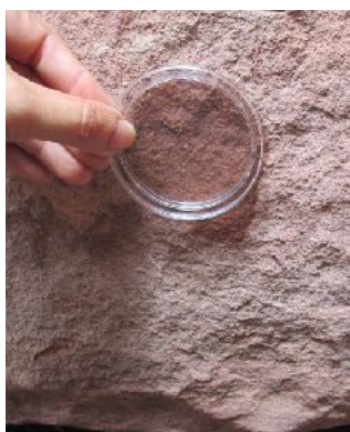
Fig.54. Diferencia de diámetro entre la esponja de la prueba y la mancha de humedad residual en el soporte rocoso.
