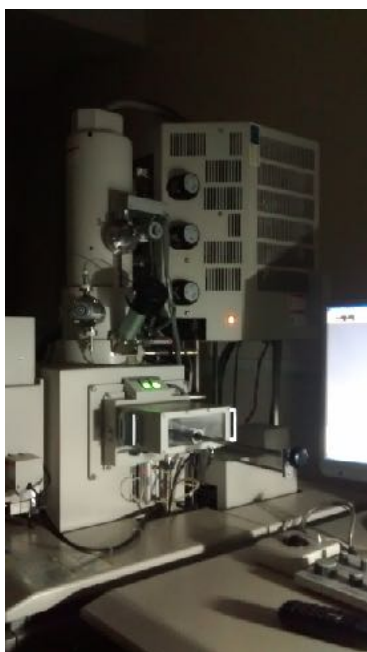
Fig.2. Microscopio Electrónico de Barrido y Microanálisis de rayos X (SEM-EDX) empleado.
