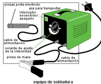
**Figura 86. Equipo de soldadura.**
