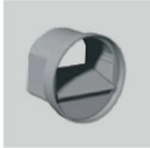
RD BP Reguladores de caudal autorregulables de baja presión. (20/100 PA) Para instalar en el interior del conducto. Diámetro 80 mm. Caudal: 15 ó 30 m 3 /h.
