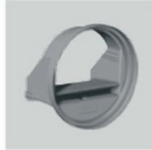
RD BP Reguladores de caudal autorregulables de baja presión. (20/100 PA) Para instalar en el interior del conducto. Diámetro 80 mm. Caudal: 15 ó 30 m 3 /h.
