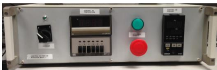
Figura [3.3.15]: Rack de temperaturas y PID
