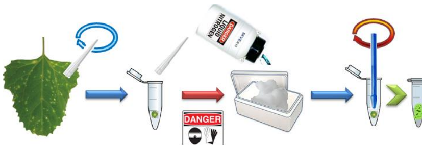
Figura 27. Esquema del aislamiento de lesiones y preparación de las mismas para su inoculación inmediata en plantas de tabaco.
