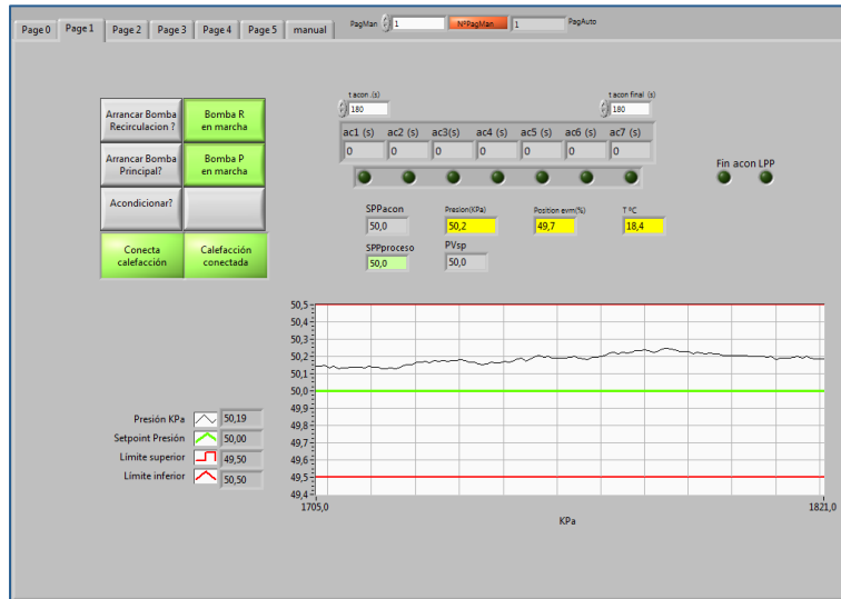
Figura 3: Pantalla de seguimiento del ensayo, control de bomba, temperatura y presiones.
