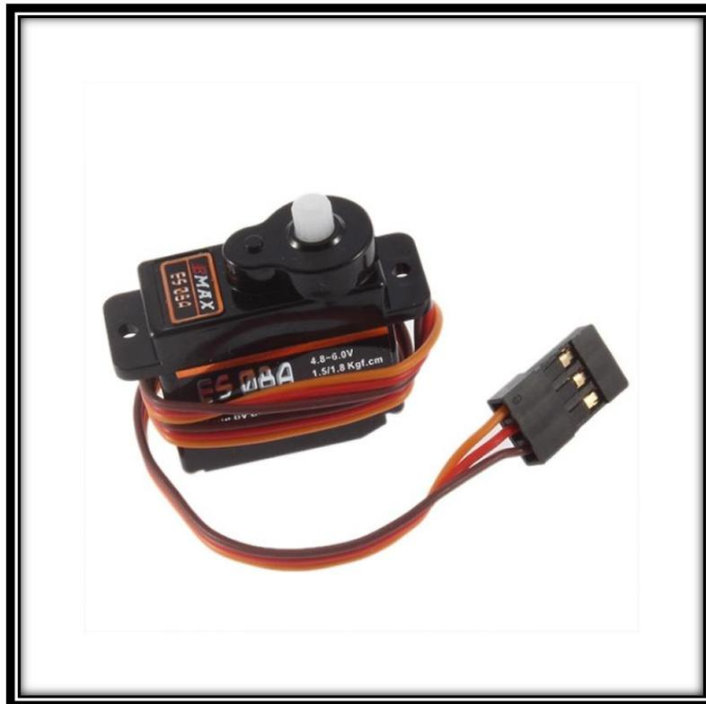
**Imagen 18.** Servomotor EMAX ES08A.
