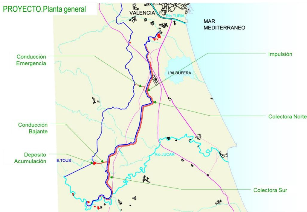
**Figura 1.** Esquema general de la instalación
