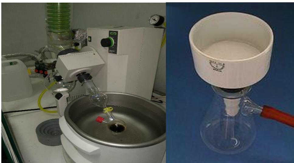
*Imagen 3.5 (Derecha) Fotografía del sistema de filtración al vacío utilizado. (Izquierda) Fotografía del rotavapor utilizado para quitar el mayor parte de agua posible.*
