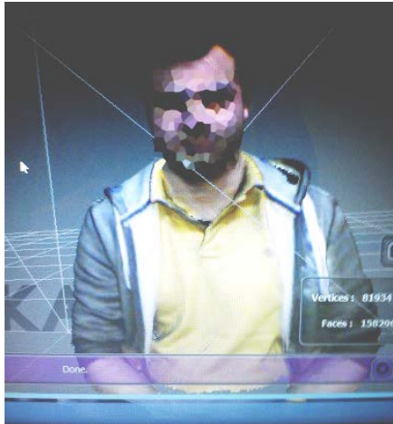
Figura 5. Ejemplo de segmentación de textura y color con volumen. La imagen muestra una captura 3D de un alumno digitalizado mediante la cámara Kinect y el software Skanect-3D. La cara ha sido voluntariamente pixelada.
