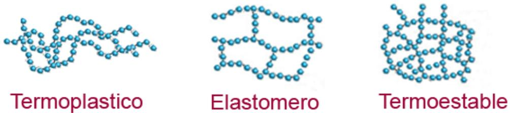
Figura I.7. Imagen esquemática de la estructura de materiales poliméricos.
