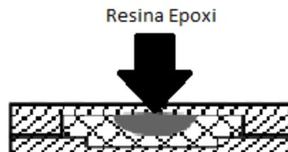
**Figura III.61.** Representación esquemática del proceso de transferencia de resina mediante inyección.
