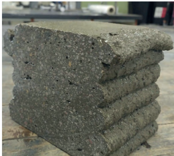
Figura 7. Imagen sección probeta impresa. BEMORE3D (2017) / Figure 7. Image of printed test tube section. BEMORE3D (2017).
