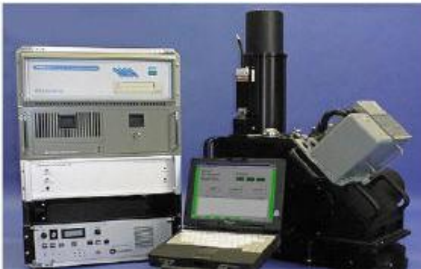
Fig.8 Sistema escaner aerotransportado (Renslow M. et al., 2000)
