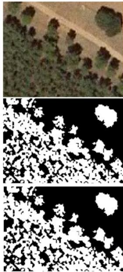
Fig.20 Determinación de la FCC a partir de datos LiDAR, para un pixel de 1x1(m). Comparación con la ortofoto (arriba).
