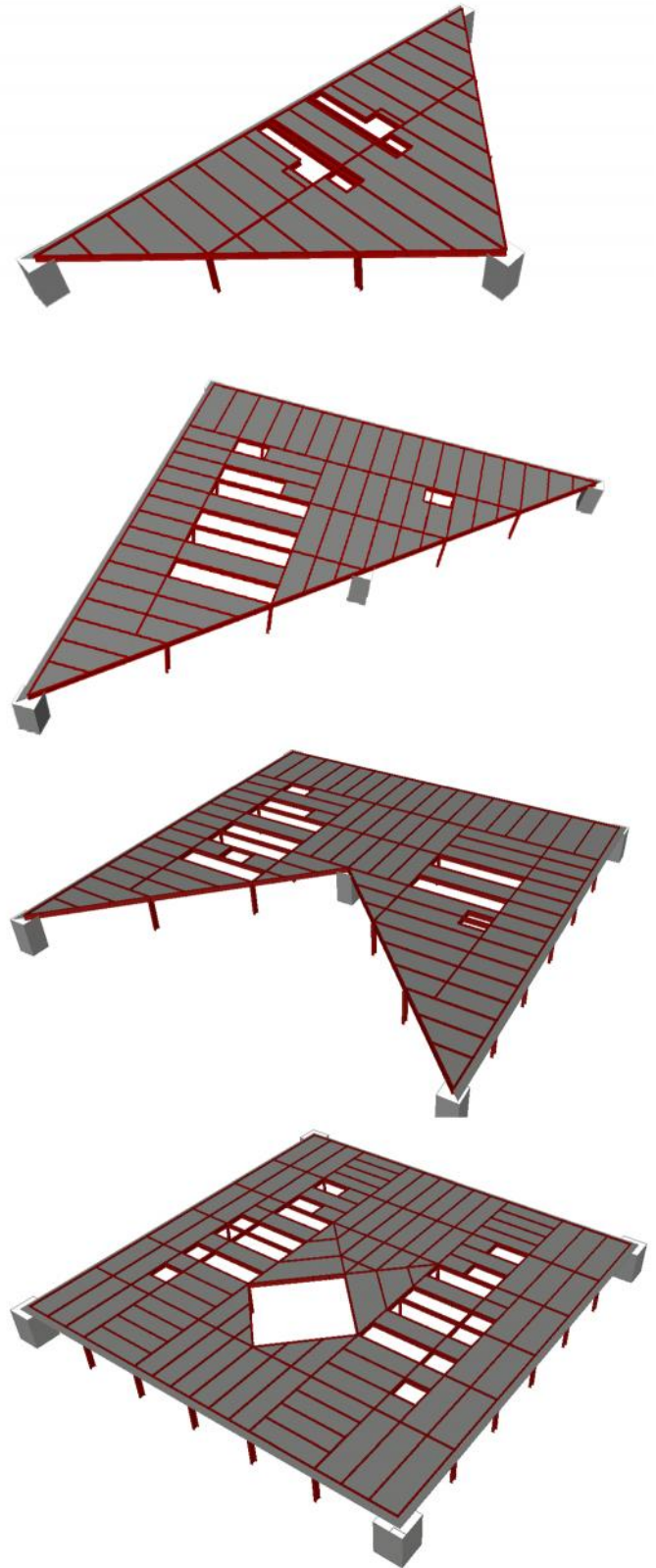
mg 2: Modelo sólido de las distintas tipologías de plantas del edificio
