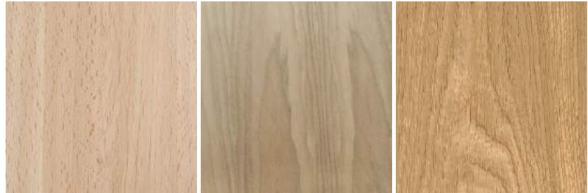
Fig.3 “Maderas duras” como son la madera de haya, de nogal o el roble, por ejemplo. El tratamiento es más complicado, resistencia notable y mayor durabilidad que el resto de maderas. El precio de este tipo de maderas es más elevado debido al prolongado crecimiento de la especie.
