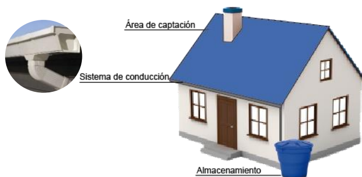
Ilustración 11. Componentes del sistema de captación más utilizado en Ecuador
