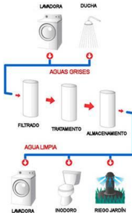
Ilustración 50. Componentes de la reutilización de aguas grises
