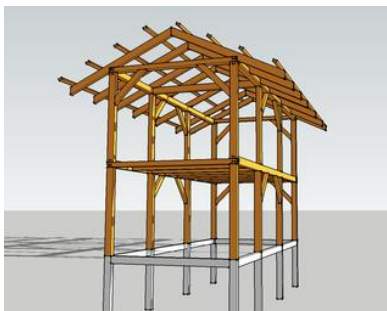
Ilustración 32. Construcción sobre pilotes
