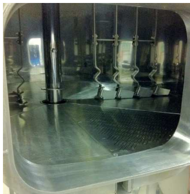
Ilustración 12 Interior cuba de filtrado
