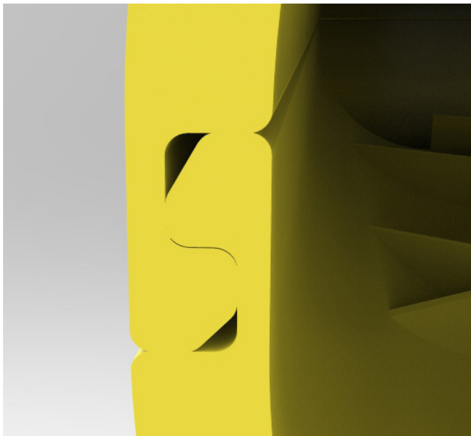
Imagen 90: Detalle juntas para el ensamblaje (Fuente: propia)
