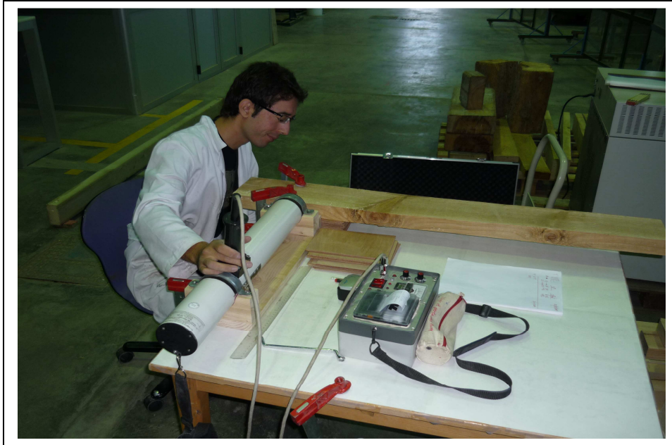
Fig. 3.3.9. Ensayo de resistencia a perforación.
