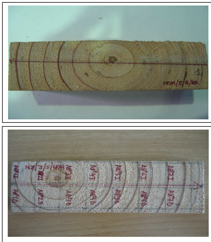
Fig.3.3.14. Ejemplo del marcado inicial de la pieza en la fotografía superior y el marcado listo para la extracción de las probetas en la fotografía inferior.
