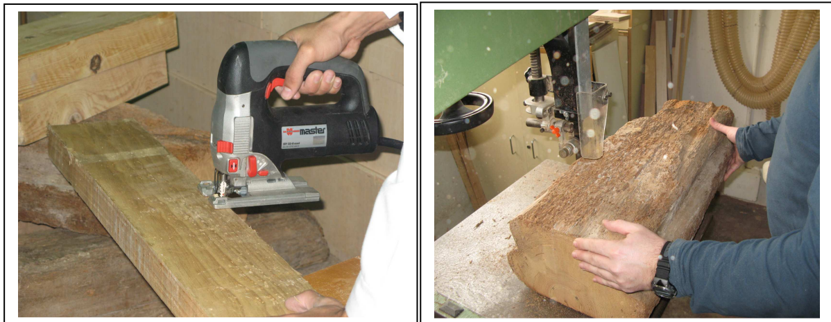
Fig.3.3.7. Sierras de corte utilizadas para el tronzado de los tablones.
