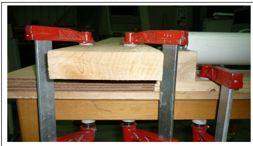
Fig. 3.2.14. Sargentos sujetando el resistógrafo y el tablón de ensayo.
