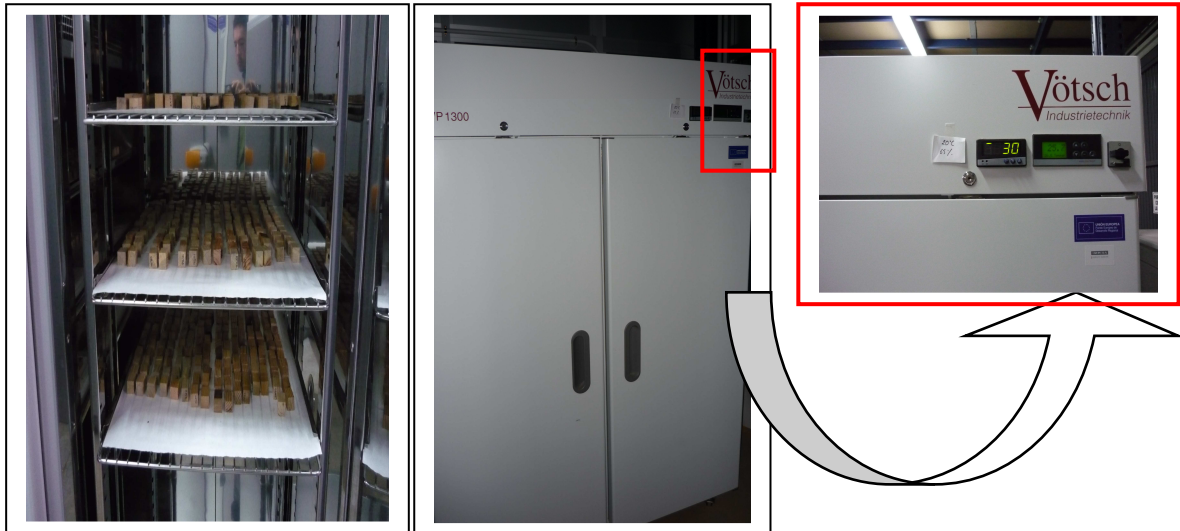
Fig. 3.2.21. Cámara de acondicionamiento.
