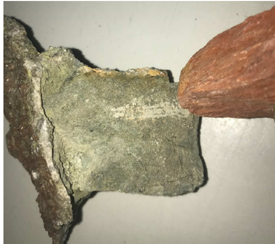
Figura 1: Yeso rayado por roca con calcita
