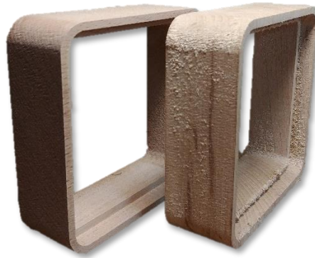
Figura 30 – Piezas del marco en distintas fases antes de su encolado
