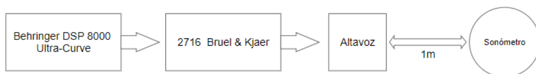
Figura 35 – Esquema del montaje en la cámara anecoica
