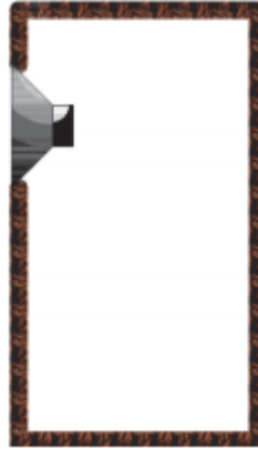
Figura 4 – Esquema de una caja cerrada
