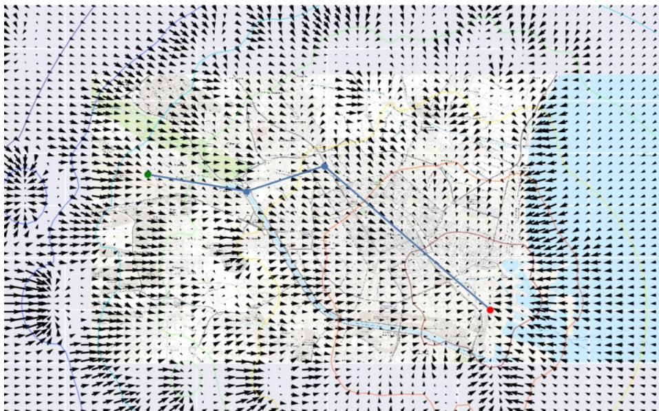
Figura 9. Efecto de atracción en el punto final de un camino (punto rojo)
