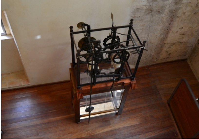
Mecanismo del reloj de la Torre en la actualidad
