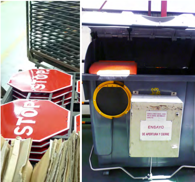
Contenedor al que se le está realizando un ensayo de apertura y cierre. Empresa Contenur
