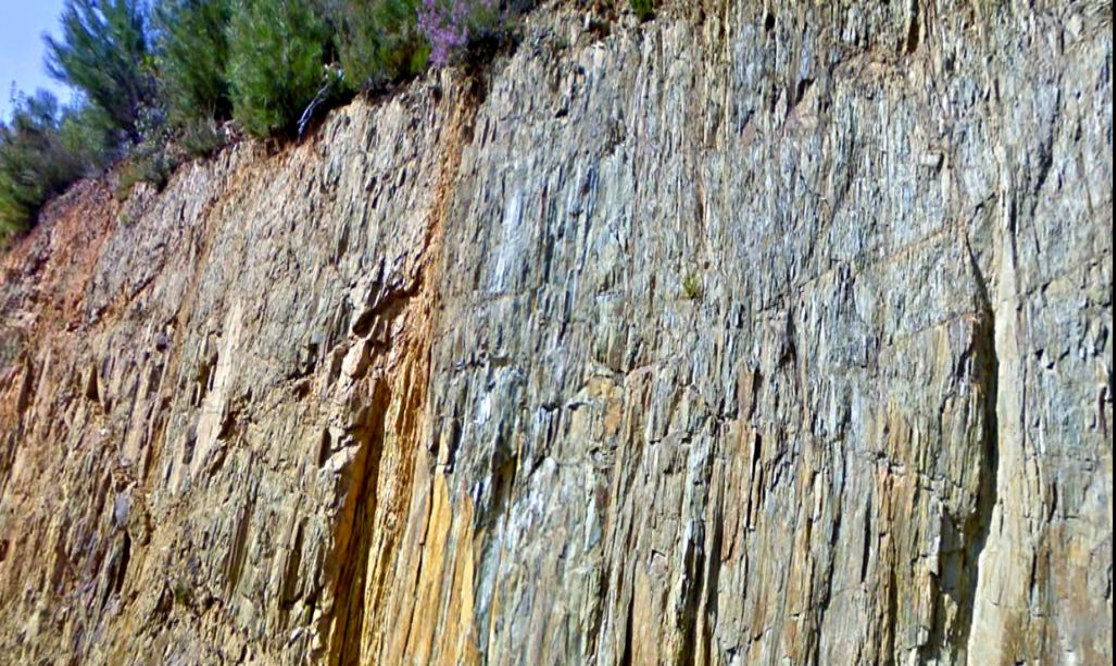
Intenso sistema de discontinuidad subvertical en las grauvacas y pizarras del Precámbrico Sup. Al S de Pedro Muñoz, S de Pinófraqueado. Centro N Hoja de Casar de Palomero, Cáceres.
