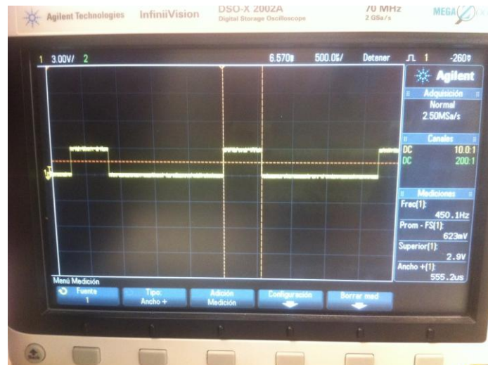
Figura 49: Vista en el osciloscopio de una señal PWM generada por la placa STM
