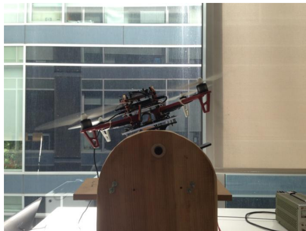
Figura 60: Vista del quadrotor con control, filtro complementario y referencia cero
