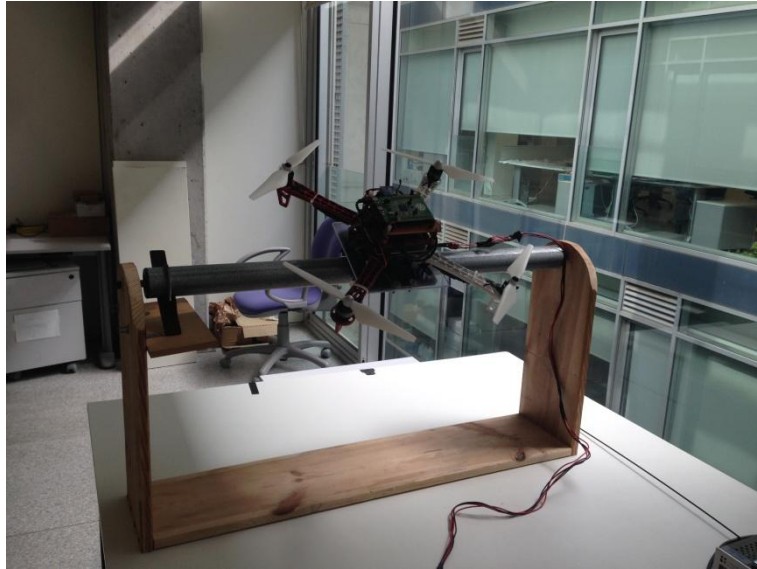
Figura 54: Vista del quadrotor montado en el soporte para las pruebas
