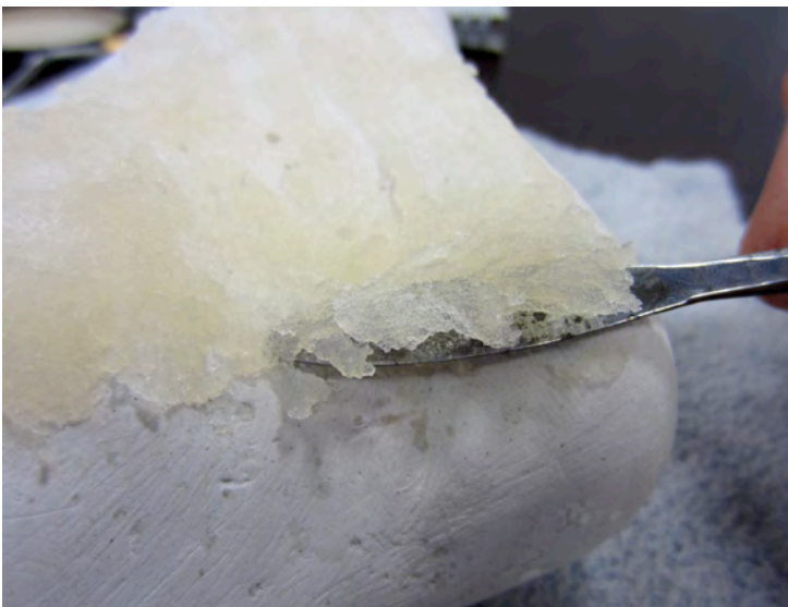
Ilustración 4 Gel de agar retirado con espátula tras la limpieza.
