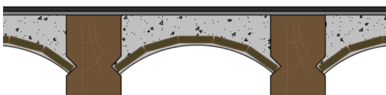
Ilustración 48.2: Forjado Revoltón. Fuente: Propia. 2016.
