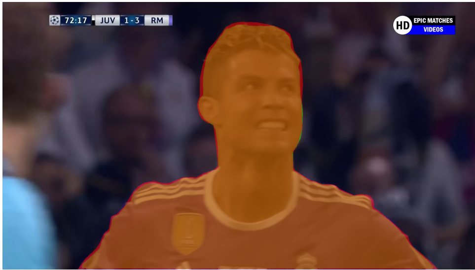
Figura 3.3: Overlay GT (verde/rojo) vs. predicción SAM (azul/amarillo) en un frame de ejemplo.
